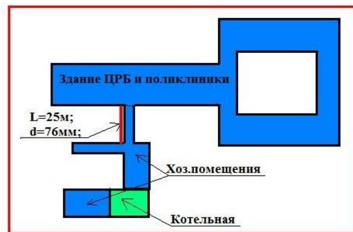
Рисунок. Схема тепловых сетей Котельной №12, Центральная районная больница
